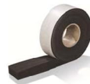
Dans tous les cas de figure il est fortement déconseillé d'ajouter un joint silicone à l'extérieur devant la mousse imprégnée de classe 1. Sa valeur  $S_d$  pour une épaisseur de 10 mm est en effet de 10 alors que celle de la mousse imprégnée est inférieure à 0,5. Le joint silicone agit par conséquent comme un frein à la migration de la vapeur d'eau qui condense ainsi dans la mousse imprégnée.
