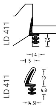
La dernière évolution combine TPE et micro mousse. La micro mousse (cellules fermées) est utilisée dans la partie fonctionnelle des joints.
